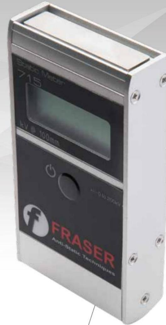
715 Static Meter는 최대 200kV를 측정하며 거의 모든 산업에서 정전기 문제를 조사하는 데 사용됩니다. 위험 지역에 대해서는 아래의 EX715를 참조하십시오.
